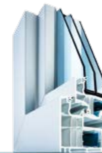
PAST 92 Kunststoff 92 mm Bautiefe U_f = 0,98 \text{ W/m}^2\text{K}
