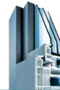
PAST 92 Kunststoff mit Alu-Vorsatzschale 92 mm Bautiefe U_f = 0,98 \text{ W/m}^2\text{K}
